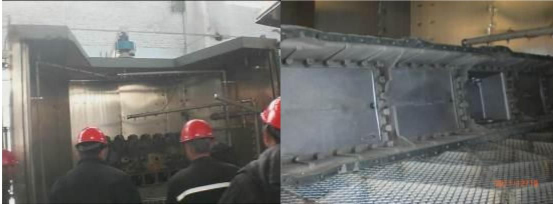
项目评判：超大型零部件清洗机，专门根据现场零部件规格尺寸设计制造，解决现场清洗难题。
