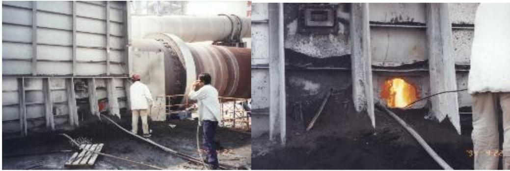
应用描述：在所有新型干法水泥窑系统中，预热器的堵塞和结皮现象普遍存在，严重影响水泥生产。每次停窑清理都会给企业造成减产和增加生产维修成本。篦冷器的堵塞导致窑内产生环流，形成结圈，增加堆雪人的概率。使用高压清洗设备加上加长喷枪，深入到窑内。窑内高温使水射流骤然汽化，产生强烈震波，将堆结的料团和结皮震碎。不用停窑，避免了企业停窑造成的经济损失。
